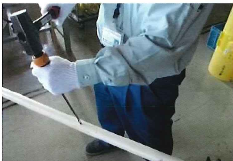
ドライバーとハンマーを用いた剥離作業とその剥離状況
