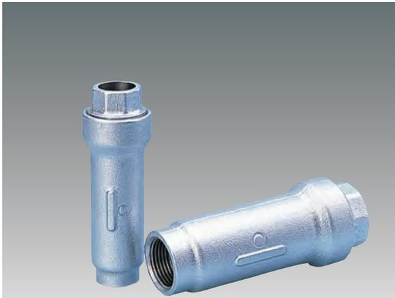
HGM(House Gas Mechanical)継手、屋内架空配管用メカニカル継手です。耐火パッキンの装備により万一の火災にも対応できる継手です
