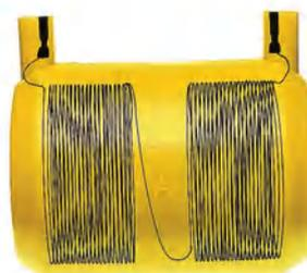
▲EF継手X線写真
