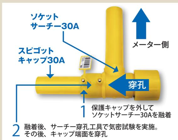
地境最小化継手のスピゴットキャップは管と同じ外径のキャップで、敷地内先行配管に使用しソケットサーチャーを使うことでスクイズオフ工具が不用で管を穿孔し、コンパクトで安全、効率的な配管作業を実現します。
